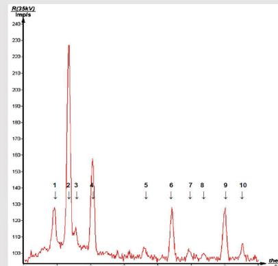
Рис. 7: Картина спектра Дебая-Шеррера образца медного порошка.
