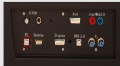
Рис. 4: Подключение компьютера
